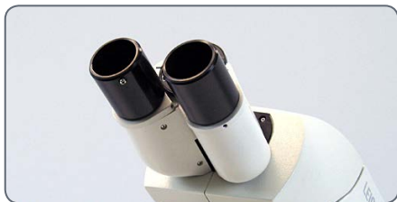
标准观察镜筒；镜筒目前不含目镜。
