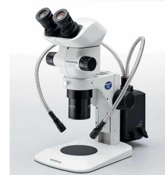
Interlock dual light guide / SZ2-LGDI
